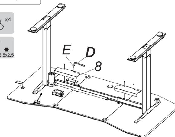
Instale (8), usando uma chave 2.5x2.5 (D) para apertar os parafusos (E).
