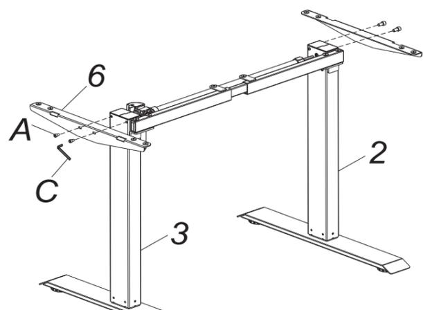
Instale (6), (2) e (3), utilize uma chave 5x5 (C) para apertar os parafusos (A).
